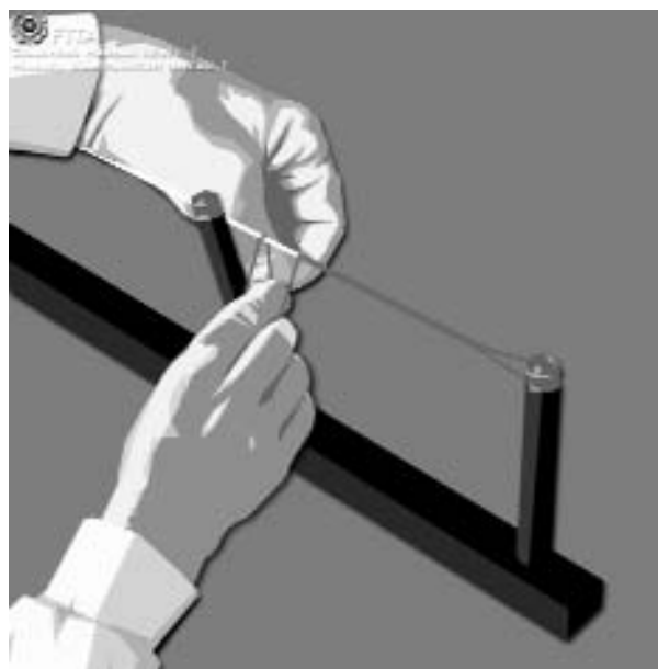
Faire un pont de fil renfort enjambant le corps de la corde, pour préparer la ligature finale.
