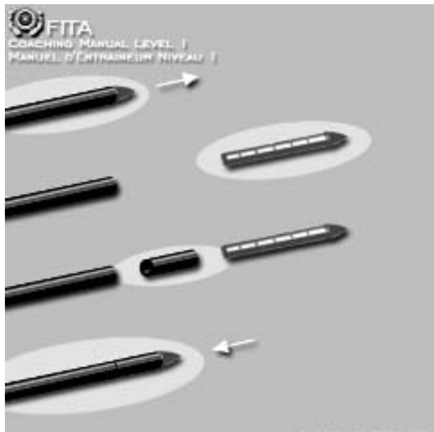
Rallonger un tube de flèche.
