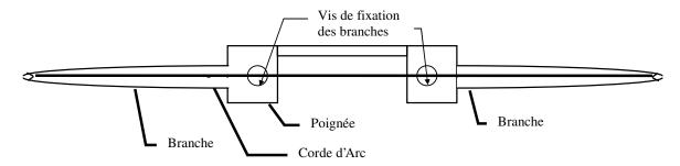
Placer l'oeil de telle sorte que la corde soit alignée avec les centres des vis de fixations des branches.
