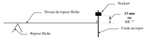
Un réglage plus fin se fait avec une flèche sans plumes, en comparant les positions relatives des impacts de flèche empennées et non empennées à 18 m. La flèche non empennée n'a pas de plumes, mais un contrepoids rétabli l'équilibre de la flèche. Avec des Spin Wing, il suffit de rabattre les plumes avec du scotch.
