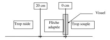
Il faut noter qu'à cette étape, une flèche non empennée arrivera au même endroit qu'une flèche empennée. Cependant, en cas de réglage initial du Berger trop loin, il est recommandé de recommencer le détalonnage et le réglage du Berger. En effet, un mauvais réglage du Berger se traduit par une perte de rendement de l'arc ce qui affecte les réglages.
